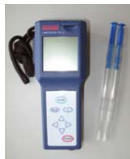
■ATP拭き取り検査器 手指、調理器具等の洗浄具合を数値で確認できます。
